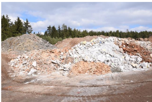
Vstupní surovina pro RCK – směsný cihelný recyklát
