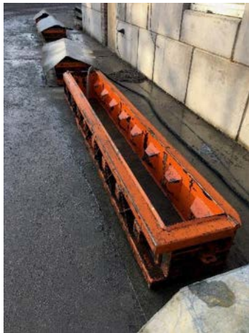
Forma prvku prefabrikovaných základů
