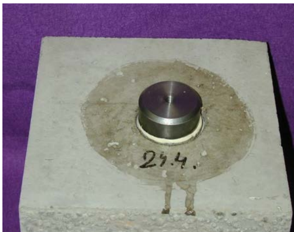
Obr. 1 Přilepení odtrhového terče k povrchu
