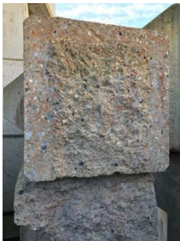
Prvky recyklovaných základů z recyklovaného betonu – na lomu
