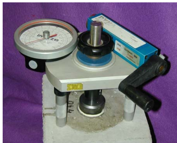
Obr. 2 Odtrh terče přístrojem DYNA Z 15
