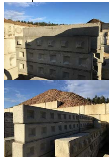
Prvky recyklovaných základů z recyklovaného betonu – po odbednění
