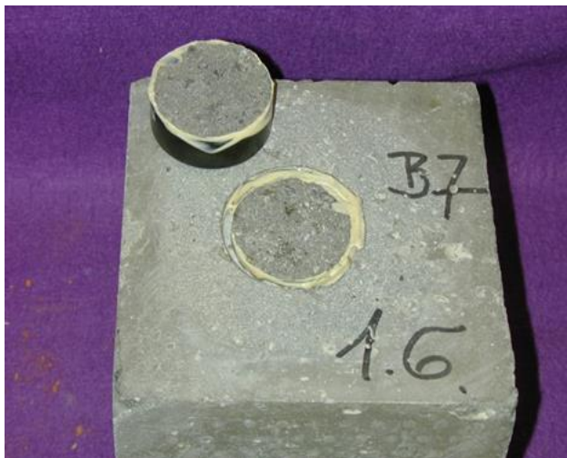
Obr. 5 Způsob odtržení penetrovaného betonového adherendu při testu přídržnosti adheziva typu I. a II.
