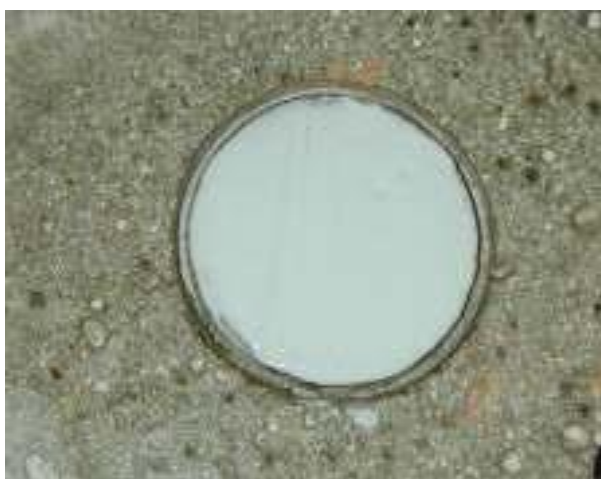
Obr. 3 Nanesené adhezivo L1 na povrchu betonu
