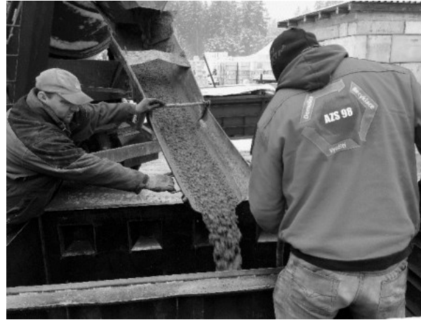
d) Plnění formy betonovou směsí s recyklovanými materiály
