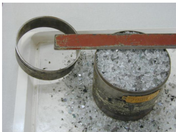
Obr. 2 Stanovení sypné hmotnosti skelného recyklátu frakce 4-8 mm a 1-2 mm
