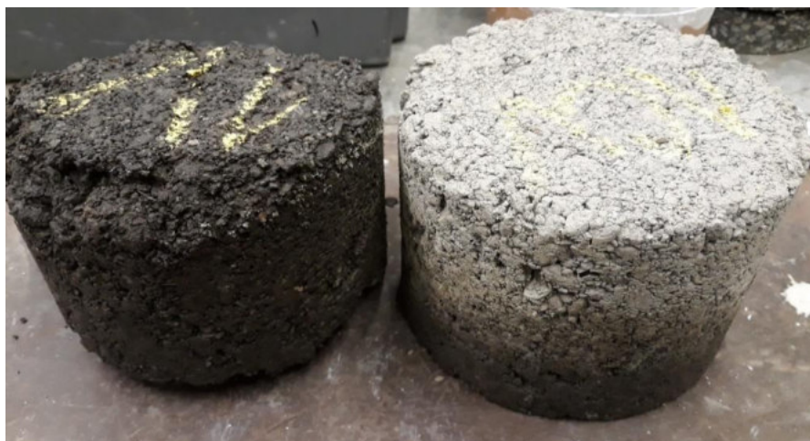
Obrázek 62: Tělesa po zmrazovacích cyklech (vlevo AP-SK, vpravo AP-SK+cement)
