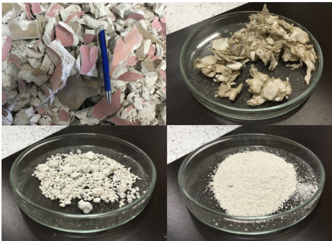
Obr. 2: Jednotlivé fáze zpracování SDK, postupně: prvotní surovina pro primární drtič, odseparovaný papír, recyklát frakce 1/5 mm a recyklát frakce 0/1 mm.
