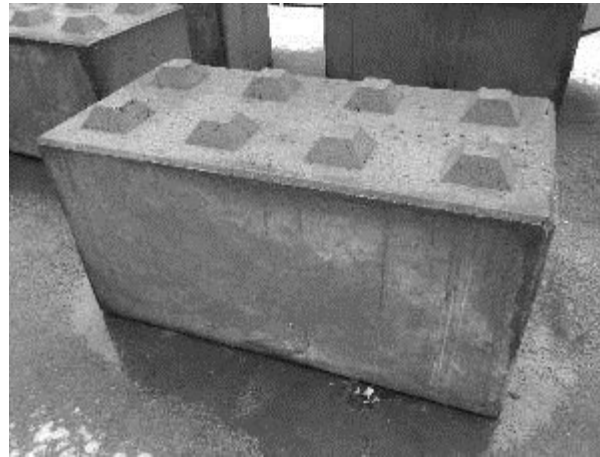
f) Zdicí prvek s recyklovanými materiály – funkční vzorek
