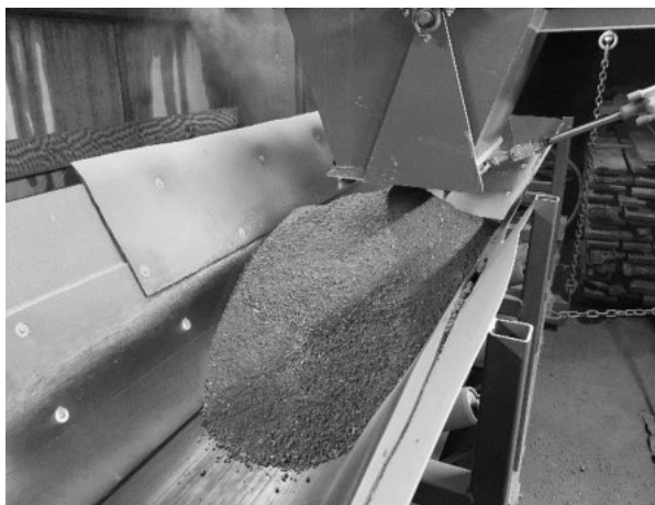
a) Navážení recyklovaného cihelného kameniva
