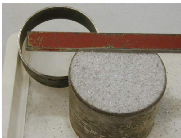
Obr. 2 Stanovení sypné hmotnosti skelného recyklátu frakce 4-8 mm a 1-2 mm
