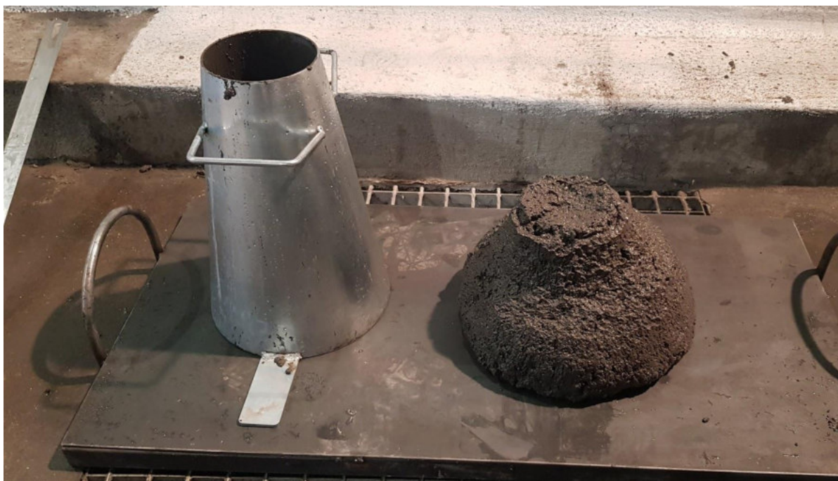
Obr. 3: Stanovení konzistence sednutím u receptury CB 1/111T.
