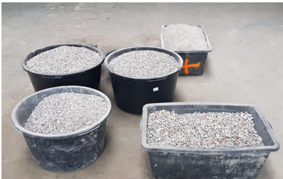
Obr. 2: Vzhled kameniva po drcení a rozdělení na jednotlivé frakce.
