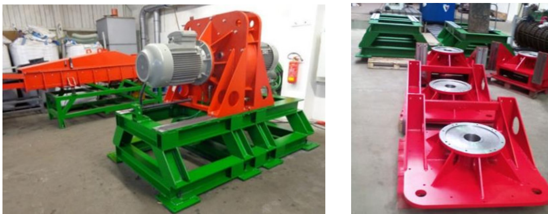
Obrázek 1: Vysokorychlostní mlýn (vpravo); rozevřené mezikruží rotorů pro osazení mlecích elementů (vlevo) [Valentin 2016]
