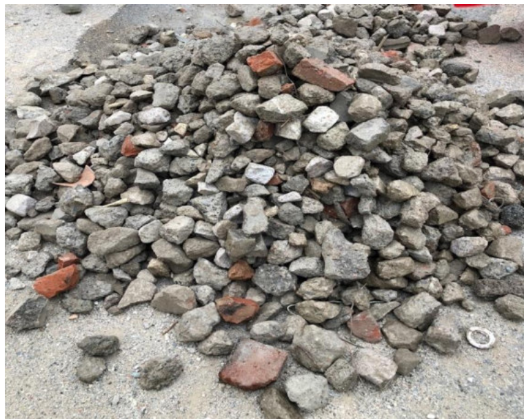
Obr. 1: Vzhled recyklovaného kameniva z Finské republiky frakce 0 – 200 mm.
